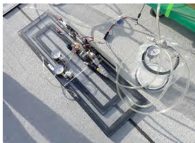
写真-4 現場透気試験
