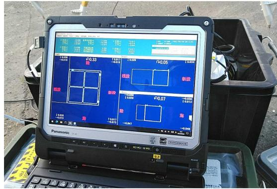
写真-3 ケーソン据付誘導システム
