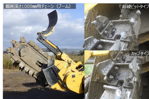
写真-2 チェーンブーム（標準）・掘削刃
