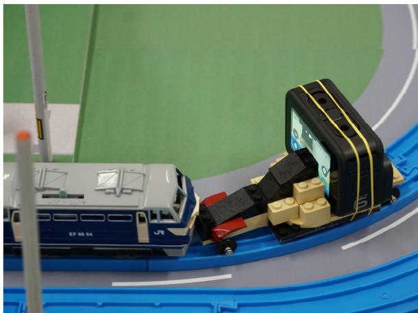
写真-7 GoProをプラレールで走らせる仕組み
