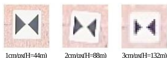
図-3 地上画素寸法の差による見え方の違い
