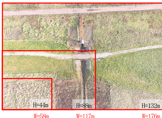
図-4 対地高度(H)と写真1枚あたりの撮影幅(W)
