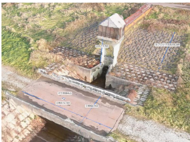
図-6 3Dモデルによる計測結果例(条件iii)
