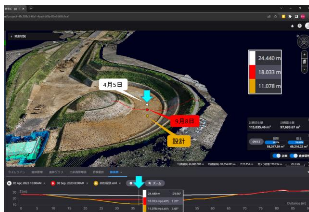
図-5 施工断面表示の例
