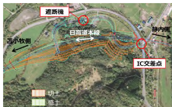
図-4 新冠ICのランプ形状と交差点、遮断機の位置
