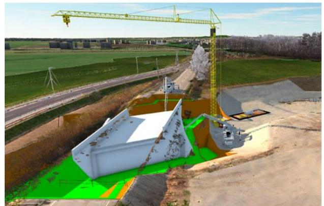
図-4 定置式水平ジブクレーンの設置シミュレーション
