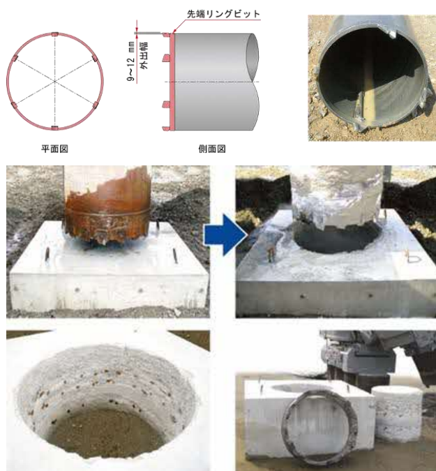
図-10 先端ビット付鋼管杭 2)
