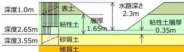
図-11 川裏側水路付近の地盤構造
