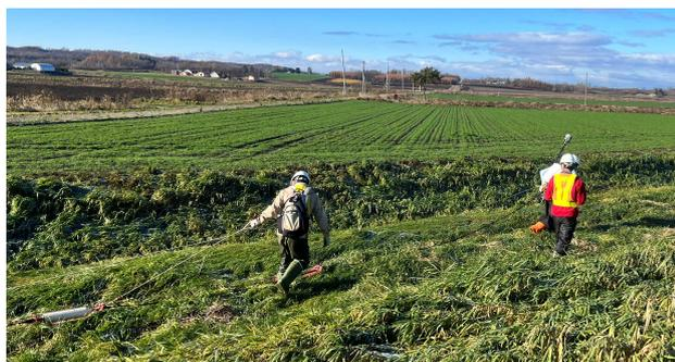
写真-3 牽引式電気探査測定状況
