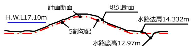
図-3 十勝川右岸36.2km堤防横断形状(縦横比2:1)
