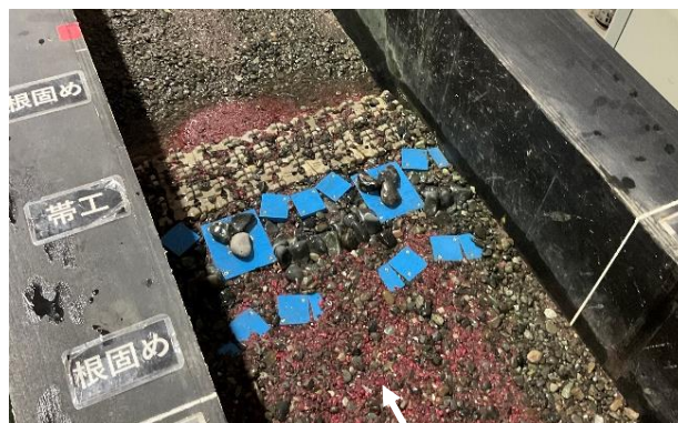
図-5 予備実験①の状況（帯工下流への着色砂の堆積）
