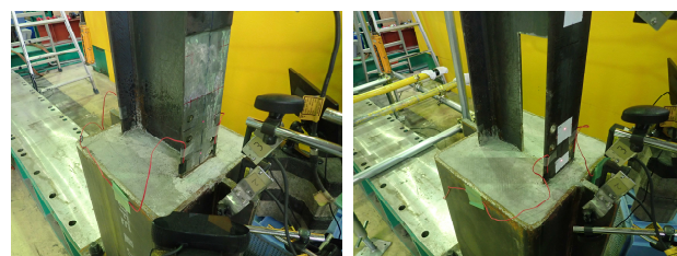
(a)引張側フランジ2mm減厚(FT2) (b)引張側ウェブ欠損(WTA)
