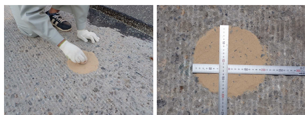
(a) 砂の敷き広げ (b) 直径の計測
