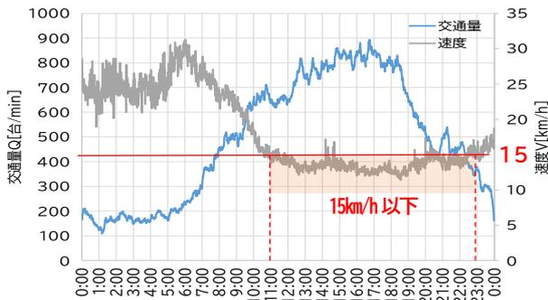
図-7 26(日)の交通量Qと速度V
