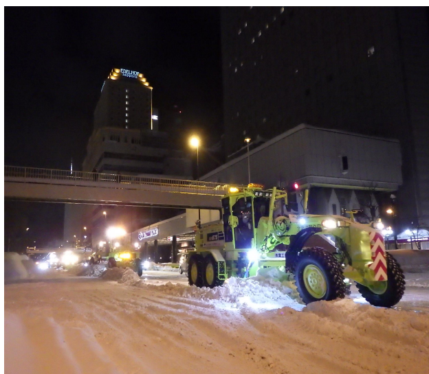
写真1 複数台の除雪グレーダによる除雪状況
