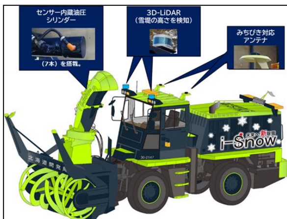
(図-5 自動化に関する設置機器)
