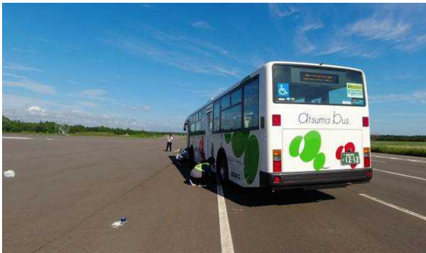
図- 10 軌跡記録状況（内輪差確認）
