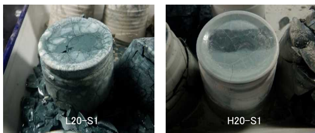
写真4 凍結融解試験 16 日目の供試体の外観 (ゼオライト内割置換率 20%、高性能 AE 減水剤 1%添加)
