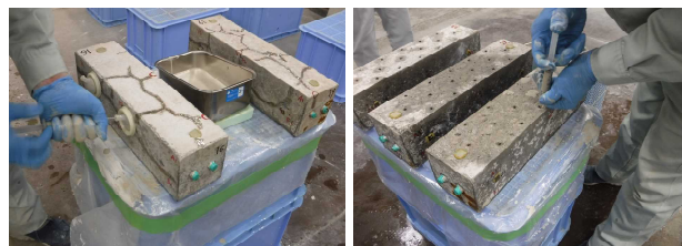
写真-7 ゼオライトの注入（左）および充填（右）
