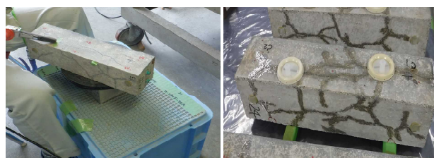
写真-6 注入前処理
