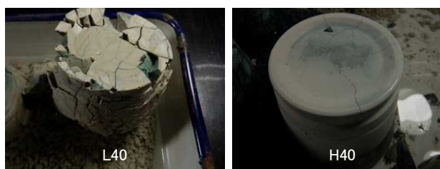
写真3 凍結融解試験 16 日目の供試体の外観 (ゼオライト内割置換率 40%、高性能 AE 減水剤未添加)
