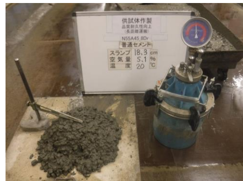
写真-1 経時スランプ変化測定に使用したコンクリート
