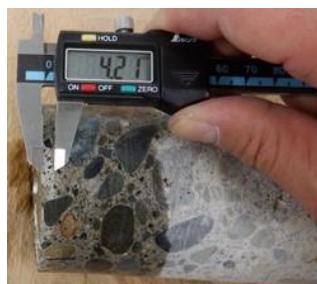
写真-1 吸水防止層の厚さ測定
