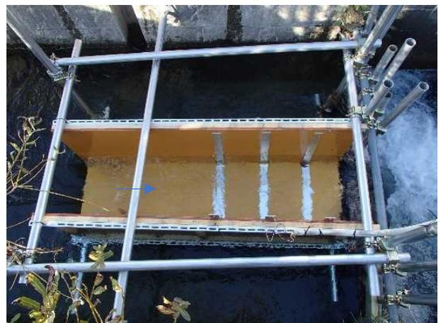
図-8 誘導水路を用いた魚カウンター現地検討の様子
