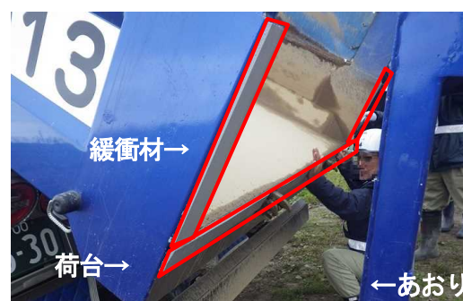
写真-7 緩衝材の取付状況（エラストイト3面取付）
