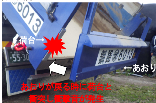
写真-5 ダンプトラックの荷下ろし時の衝撃音
