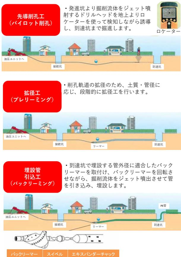
図-2 テラ・ジェット工法の原理<sup>1)</sup>
