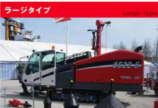
写真-2 テラ・ジェット工法 施工機種<sup>1)</sup>
