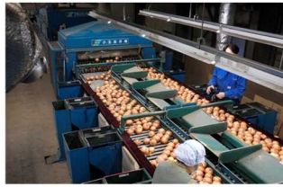
写真16 小玉抜き機と1次手選別ライン
