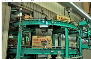
写真6 二段構造のコンベア （上:10kg箱、下:20kg箱）
