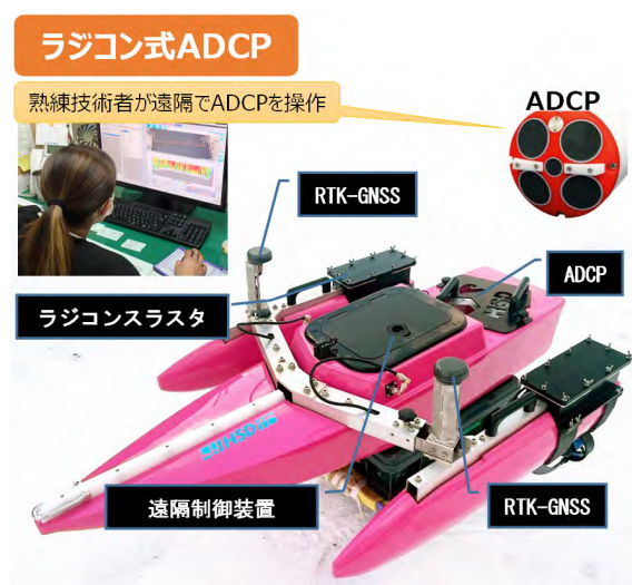
図-1 ラジコン式 ADCP の概要
