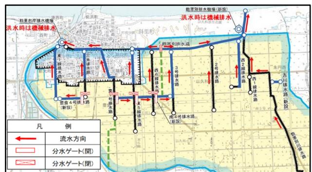
図-9 流水方向(洪水時)
