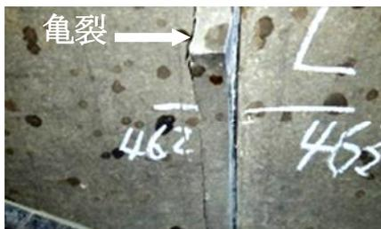
写真-3 管の亀裂
