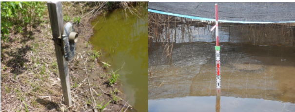
写真-5 インターバルカメラによる水位のモニタリング
