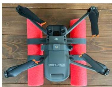
写真-4 水没対策用のフロートを取り付けたUAV
