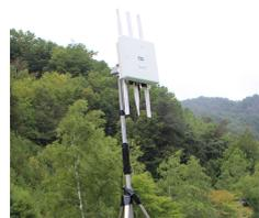
写真-1 アクセスポイント (三脚の上に設置)
