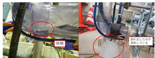
写真-4 凍結膨張による管路の破損
