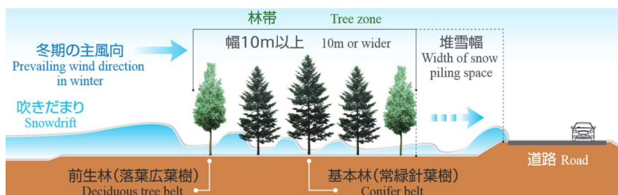
図－2 標準的な防雪林における堆雪状況横断面図
