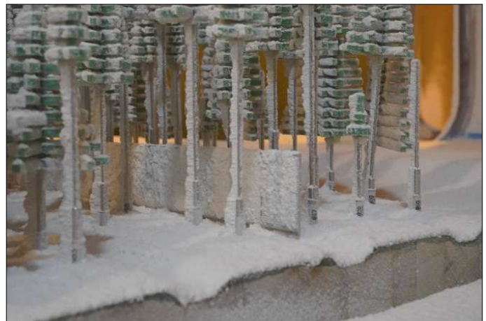
写真-4 活性白土を用いた林帯内の積雪・着雪再現状況
