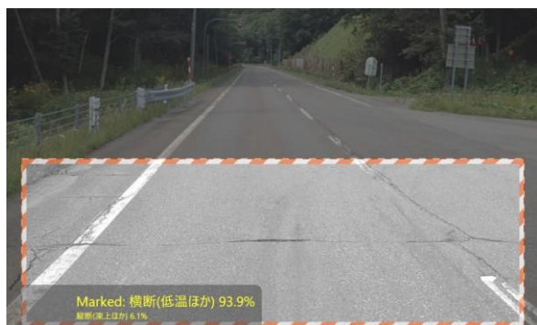
図-6 深層学習を用いた画像解析結果の例 (分類判別結果の一例：低温ひび割れの例)
