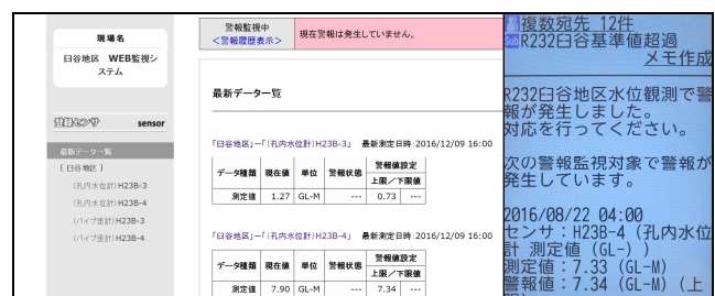
図-4 Web監視画面（左）と予告警報メール（右）
