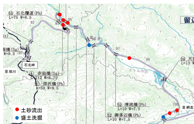
図-4 国道39号石北峠の被災箇所
