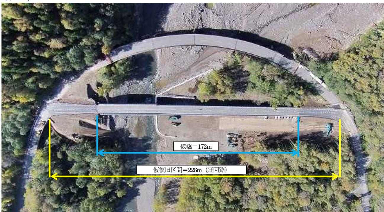
写真8：完成した迂回路
