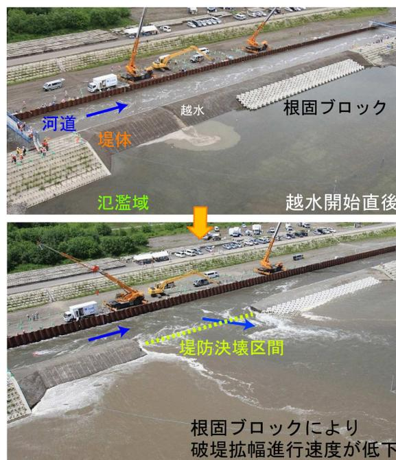
図-9 千代田実験水路での破堤拡幅抑制工実験
