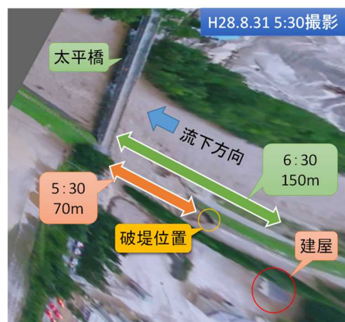
図-12 破堤長の変化
