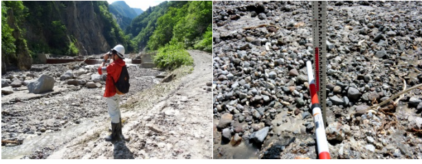
写真-1 現地調査の様子（左がレーザー距離計による計測、右がスタッフによる痕跡深の測定）
