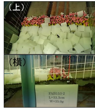
写真-3 被災相当波浪作用後の状況
