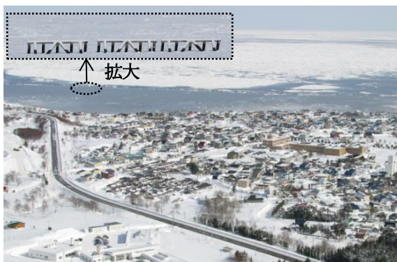
写真-2 防水柵による海水の制御状況
