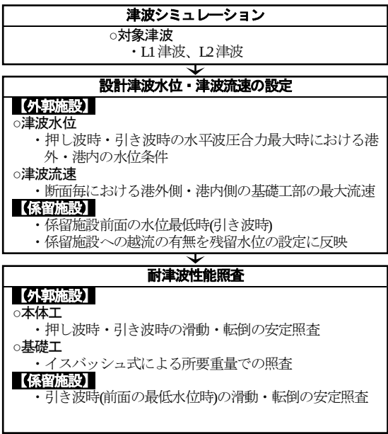
図-2 耐津波性能照査の検討手順
