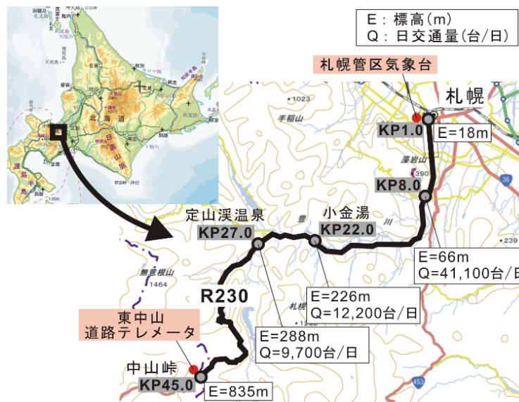
図-4 実道での路面温度・気温測定の概要
