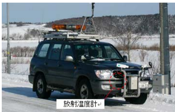
写真-1 TM 作成のための走行試験の様子
