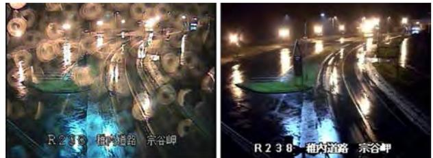
降雨時 従来型カメラ 降雨時 簡易カメラ
