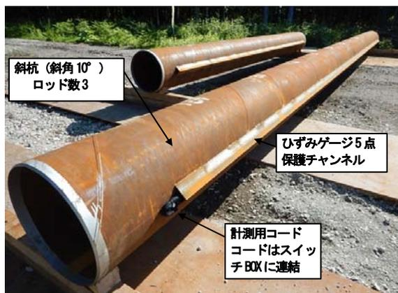
写真-2 A1橋台斜杭ひずみゲージ貼設（下面Aと上面B各5点）
