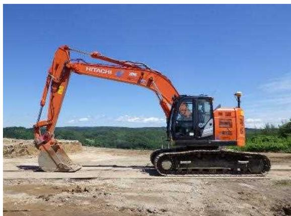
写真-3 使用した 3DMG バックホウ
