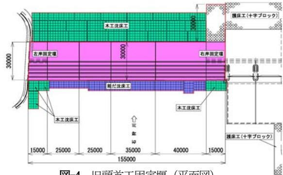
図-4 旧頭首工固定堰 (平面図)
