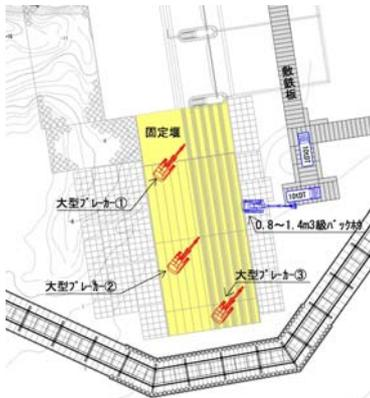
図-7 固定堰撤去時の重機配置図
