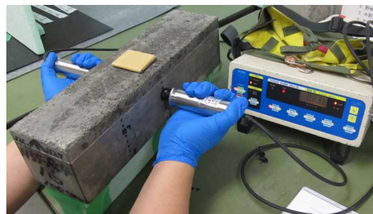
写真-2 超音波測定状況
