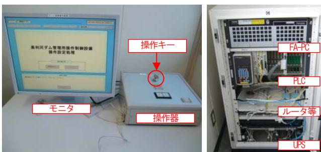
図4 遠隔操作装置の構成
