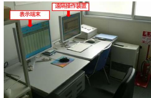
図8 遠隔操作装置と表示端末の配置
