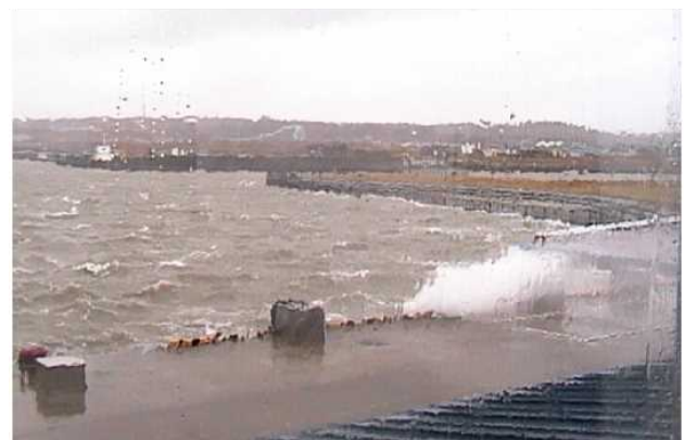
写真-5 台風23号の接近に伴う港内擾乱状況 (平成27年10月8日15時 H_{1/3}=0.46m 波向NW)
