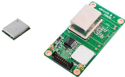
マルチGNSS基準周波数発生器「GF-8805」
