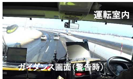
▲前方障害物探知ガイダンスによる走行実験
