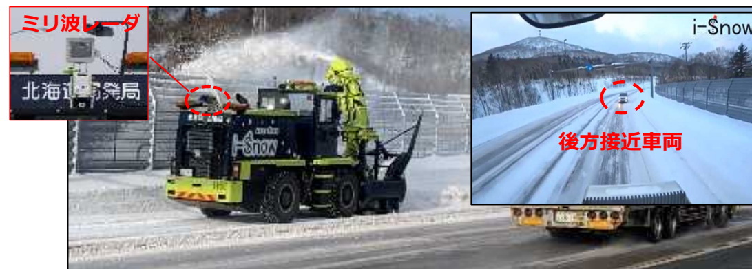
▲i-Snow実証実験における後方車両検知状況
