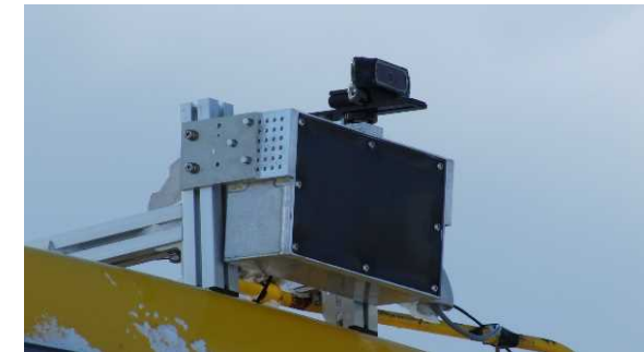
除雪トラックへのミリ波レーダ搭載状況
