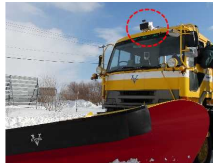
除雪トラックへのミリ波レーダ搭載状況
